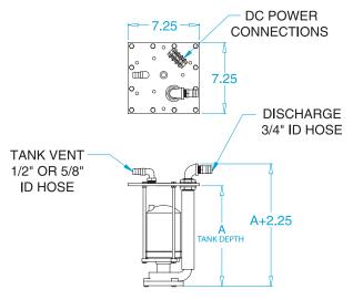
NOTE: FITTINGS ON PUMP FLANGE HAVE BEEN RELOCATED FOR CLARITY
